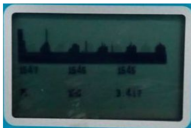
图 9 变频器干扰的回波图形
