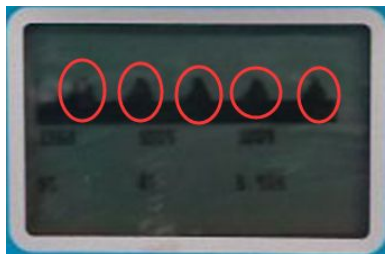
图 7 变频器干扰的回波图形
