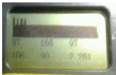
图 11 探头缩在接管内的回波
