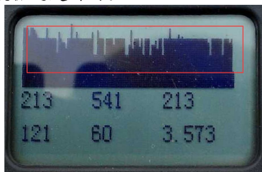
图 10 强烈干扰的回波图形
