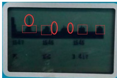
图 9 变频器干扰的回波图形
