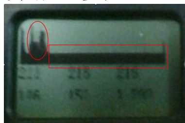
图 12 探头拿出接管后的回波
