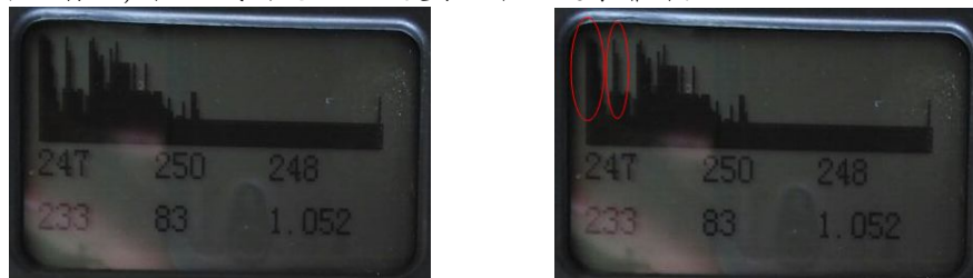
图4 探头抬高后的回波图
